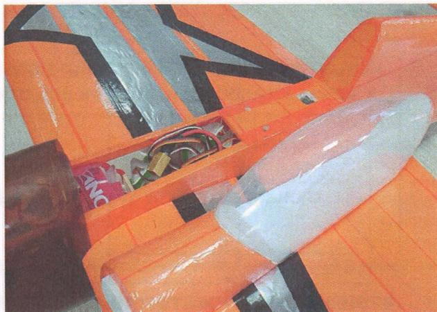
Для изготовления объемных частей фонаря кабины пилота и капота двигателя была выбрана технология термоформовки ПЭТ-бутылки на твердом болванке из дерева. Для этого на болванку надевается пластиковая бутылка и нагревается строительным феном. Бутылка осаживается и приобретает форму болванки.
