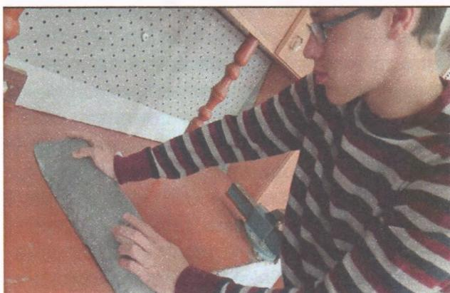
Рисунок 4 - Обработка корпуса наждачной бумагой средней зернистости
