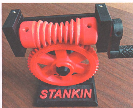
Рисунок 6 — Макет червячного механизма, изготовленный на 3D-принтере студентом И.Р. Паленовым
