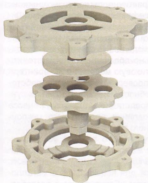
Рисунок 2 — 3D-модель циклоидального механизма в системе T-FLEX CAD
